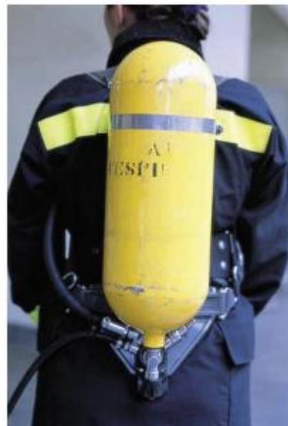
Posição do cilindro de ar comprimido
